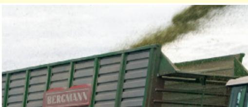
Un volet, de 600 mm, rabattable hydrauliquement facilite le détournage des parcelles sans interruption.
