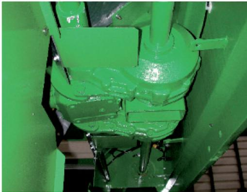
Le fond mouvant est entraîné mécaniquement des deux côtés (lors d'un équipement avec 2 moulins doseurs – version S). Si la remorque n'est pas équipée de moulins doseurs, alors le fond mouvant est entraîné hydrauliquement des deux côtés (ou mécaniquement sur demande).
