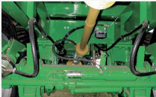
Un essieu suiveur à blocage hydraulique assure une excellente maniabilité de la remorque et protège par la même occasion le sol, l'herbe et les pneus.
