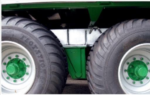
Le point de pivot de la suspension, de type Boggie avec ressorts paraboliques, est situé sous le centre des roues et des essieux. Cela optimise le confort de conduite sous charge, même dans les sols lourds. L'agrégat de suspension demande moins de puissance et les roues franchissent aisément les obstacles.
