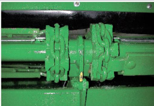
Le fond mouvant est composé de quatre chaînes robustes de 14 x 50 mm de type marine en acier (charge de rupture totale de 100 tonnes, 4 x 25 t) et de lattes massives boulonnées. Pour une fonctionnalité et une durabilité maximale, même lors de conditions extrêmes.
