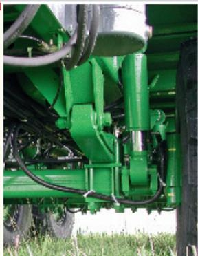
Système de suspension hydraulique. Le poids est réparti de manière égale sur les quatre roues. La course maximale des vérins (jusqu'à 300 mm) assure un débattement exceptionnel, surtout en terrain accidenté.
