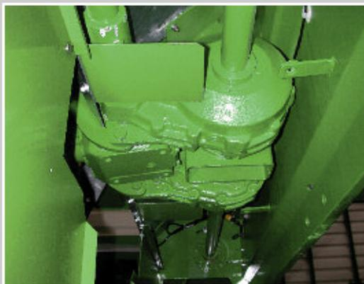
Скреповый транспортёр с механическим двухсторонним приводом ( в исполнении с двумя дозирующими вальцами) Прицеп не оснащённый дозирующими вальцами имеет двухскоростной гидравлический привод.
