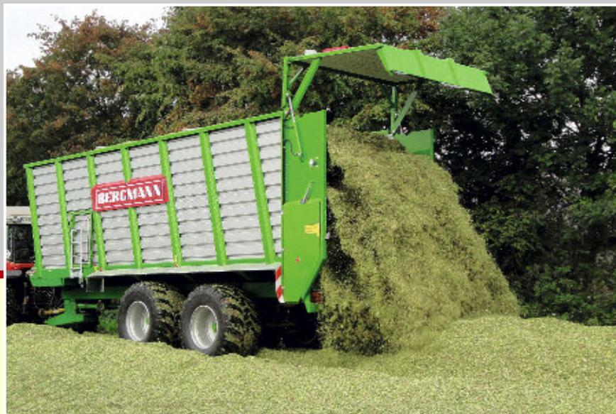
Кузов имеет коническую форму для оптимальной разгрузки кормовой массы. В течении одной минуты прицеп полностью опорожняется.
