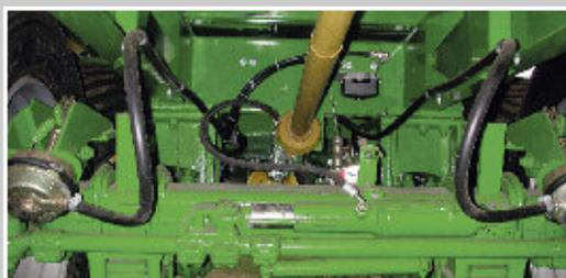
Гидравлически блокирующаяся поворотная ось следящего типа гарантирует оптимальную манёвренность и бережное отношение к корневой системе, почве и шинам.
