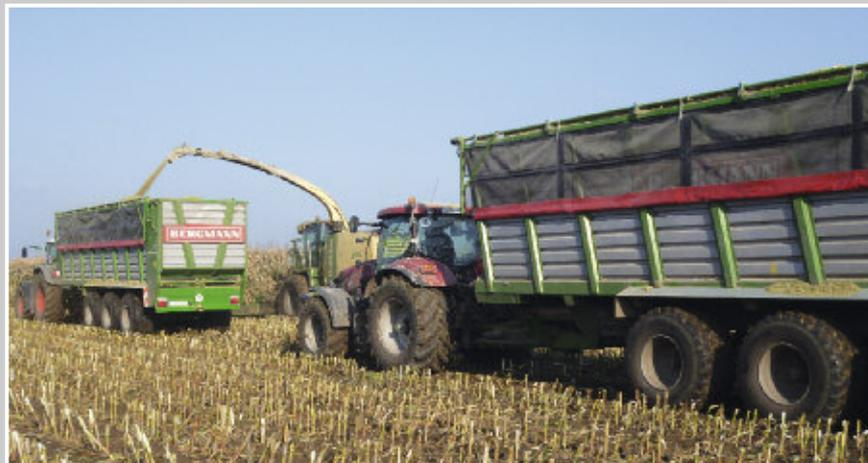
Все модели прицепов для транспортировки силоса опционально оснащаются тентом с гидравлическим управлением.
