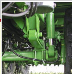
Гидростатическая подвеска обеспечивает равномерную нагрузку на колеса. Большие хода гидроцилиндров (до 300 мм) обеспечивают хорошие ходовые качества даже на пересеченной местности. (Опция) Гидравлически блокирующаяся поворотная ось следящего типа гарантирует оптимальную манёвренность и бережное отношение к корневой системе, почве и шинам.
