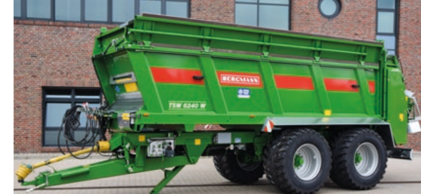
BERGMANN TSW 6240 W (W = ważenie) TSW 6240 W wyposażony jest w wersji seryjnej w urządzenie ważące za pomocą sensorów wagowych o wysokiej rozdzielczości i dużej dokładności.
