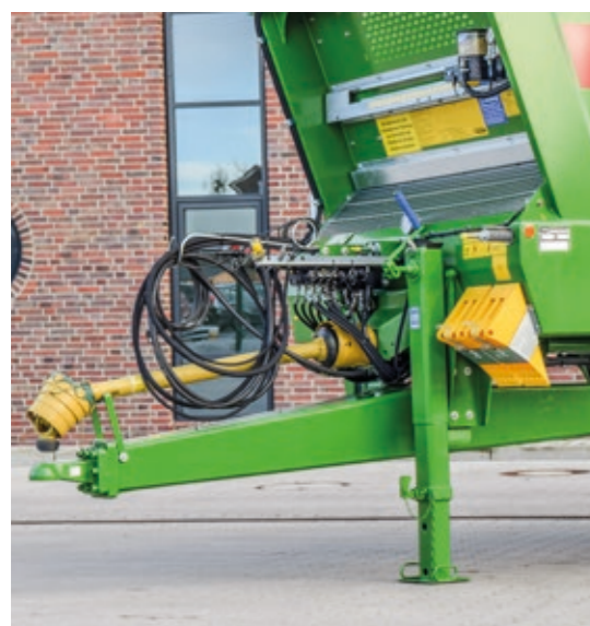
Za pomocą podkładek dystansowych wysokość dyszla ustawia się indywidualnie dla każdego ciągnika. Elementy amortyzujące zapewniają wysoki komfort jazdy. Opcjonalnie dostępna hydrauliczna amortyzacja dyszla.
