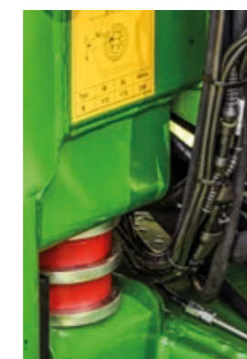
Za pomocą podkładek dystansowych wysokość dyszla ustawia się indywidualnie dla każdego ciągnika. Elementy amortyzujące zapewniają wysoki komfort jazdy. Opcjonalnie dostępna hydrauliczna amortyzacja dyszla.
