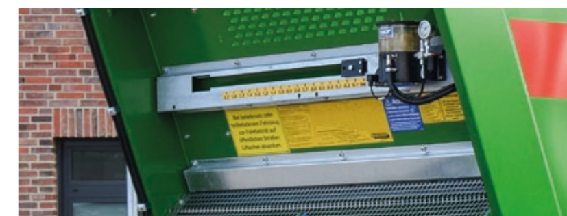
W wersji seryjnej z dokładnym wskaźnikiem wysokości zasuwę piętrzącej . Opcjonalny układ centralnego smarowania umożliwia ciągłe i indywidualnie dopasowane smarowanie poszczególnych punktów smarowniczych, co powoduje znaczne zredukowanie czynności konserwacyjnych. Dolna kratka ochronna umożliwia dobry podgląd na łańcuchy przenośnika podłogowego. Dobry podgląd na skrzynię ładunkową i przenośnik podłogowy jest możliwy przez wizjery ściany przedniej.
