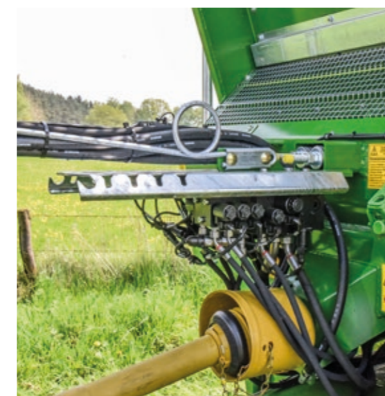
Dla poprawienia wygody obsługi TSW 6240 S można wyposażyć do wyboru we własny hydrauliczny blok sterowniczy oraz różne warianty sterowania .
