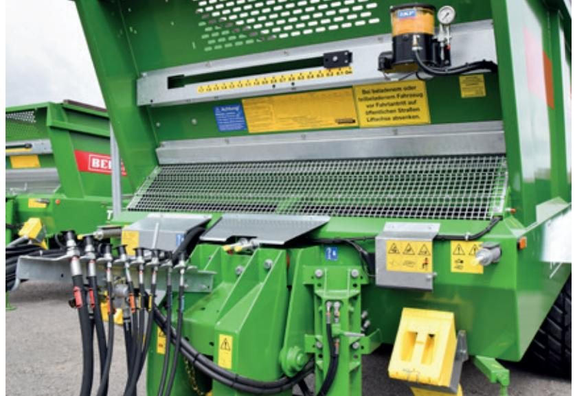
Standard, cu **indicator de înălțime blocator culisant**. Sistemul central de lubrifiere optional oferă un flux continuu de lubrifiant, adaptat pentru fiecare lagăr individual. Astfel, eforturile de întreținere sunt reduse în mod considerabil.
