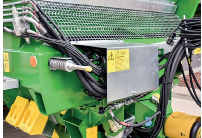
Pentru a facilita utilizarea, TSW 7340 S poate fi echipat optional cu un **bloc de comandă hidraulic** și diverse **variante de comenzi**.
