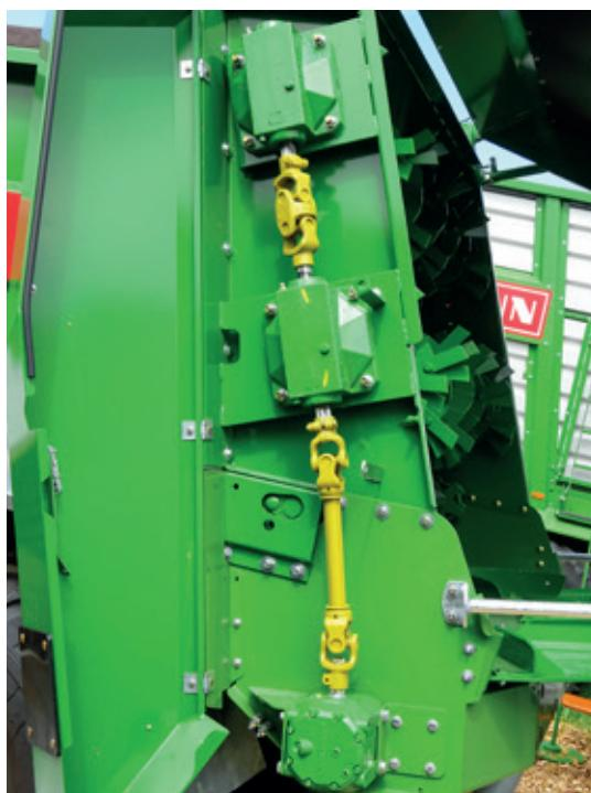
**Sistemul de acționare al mecanismului de împrăștiere** standard cu doi cilindri – per transmisie. Întinzătoarele de lanț cu închidere prin resort asigură o transmisie optimă și un grad redus de uzură (stânga).
