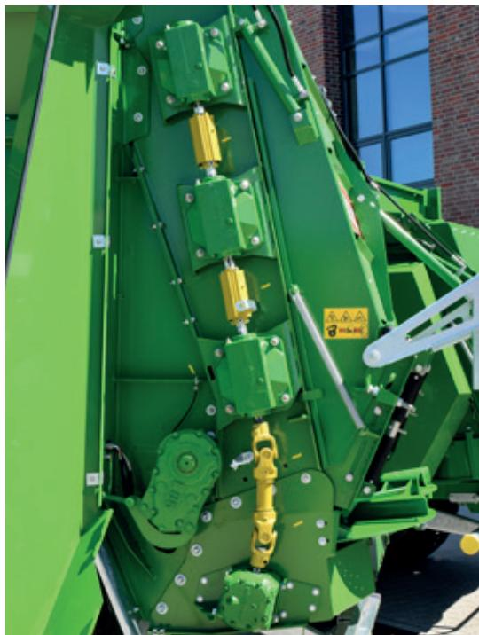
**Sistemul de acționare al mecanismului de împrăștiere** standard cu doi, optional trei cilindri – per transmisie. Întinzătoarele de lanț cu închidere prin resort asigură o transmisie optimă și un grad redus de uzură (stânga).
