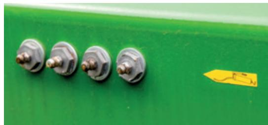
Toate **punctele de lubrifiere** sunt ușor accesibile sau grupate în blocuri de lubrifiere pentru o întreținere rapidă și ușoară.
