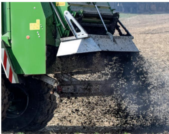
**Dispozitivul optional pentru limitarea dispersării** cu acționare hidraulică și comutabil previne contaminarea străzilor, aleilor, a canalurilor de apă, etc și asigură o dispersare precisă pe marginea câmpurilor și o fertilizare uniformă a câmpului, până la marginea acestuia.
