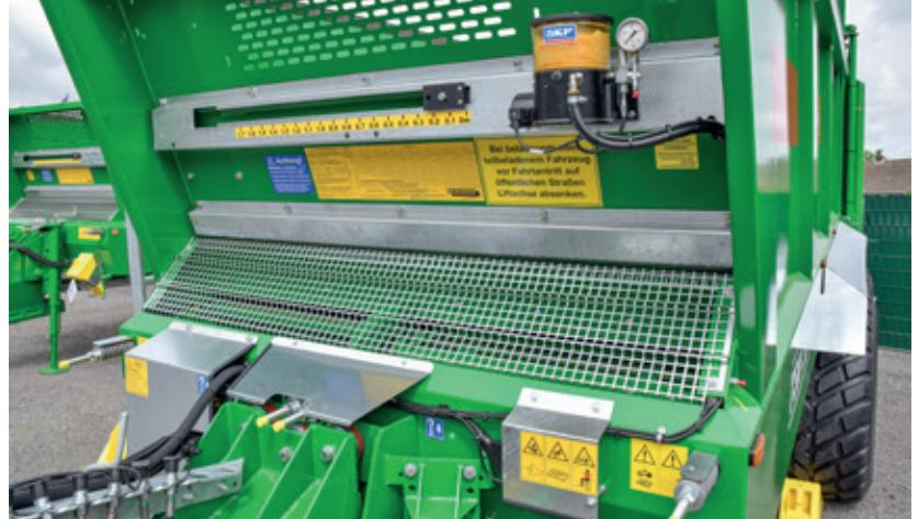
Standard, cu **indicator de înălțime blocator culisant**. Sistemul central de lubrifiere optional oferă un flux continuu de lubrifiant, adaptat pentru fiecare lagăr individual. Astfel, eforturile de întreținere sunt reduse în mod considerabil.
