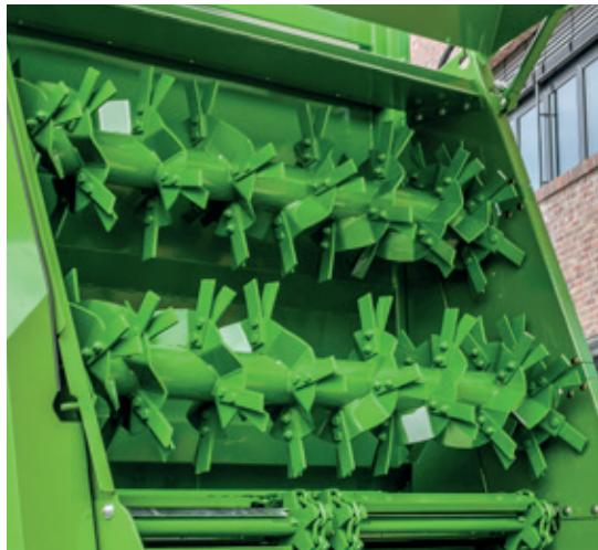
**Mecanismul de împrăștiere** cu bloc ator culisant hidraulic și dimensiune 1.400 mm poate fi utilizat pentru toate tipurile de materiale de dispersie. Sfredelele cu dinți dubli din material foarte rezistent, slab coroziv asigură o capacitate ridicată de perforare.
