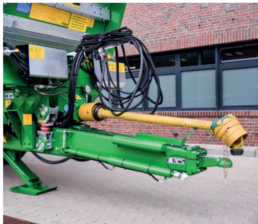
**Oiștea pentru bară de tractiune inferioară reglabilă pe înălțime, bazată pe arc și picior de suport hidraulic față.**
