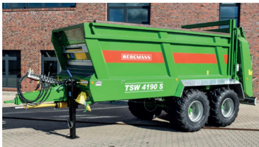
**Opțional, bară de tracțiune superioară sau inferioară, cu oîște bazată pe arc, reglabilă pe înălțime, pentru un conform sporit în timpul condusului și o stabilitate bună la rulare.**
