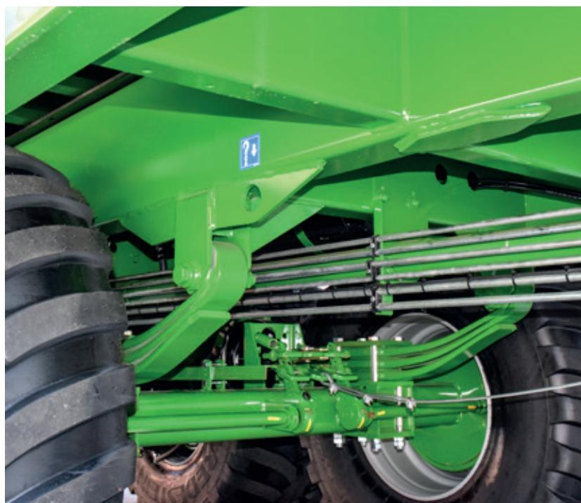
Cu ajutorul șaibelor de distanțare, **înălțimea oisții** este reglată în mod ideal pentru fiecare tractor. Elementele de suspensie asigură un grad ridicat de confort în timpul con dusului.
