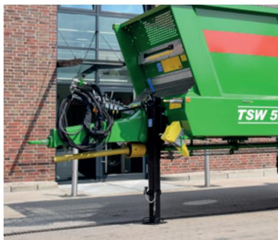
**Opțional, bară de tracțiune superioară sau inferioară, cu oîște bazată pe arc, reglabilă pe înălțime, pentru un conform sporit în timpul condusului și o stabilitate bună la rulare.**
