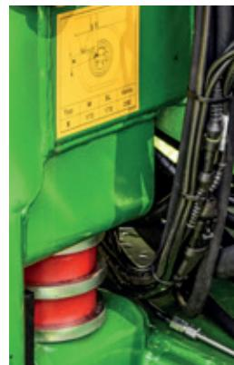
Cu ajutorul șaibelor de distanțare, **înălțimea oiștii** este reglată în mod ideal pentru fiecare tractor. Elementele de suspensie asigură un grad ridicat de confort în timpul condușului. Optional, există și o oiște prevăzută cu arcuri.
