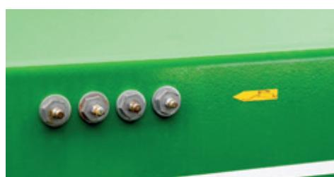
Toate punctele de lubrifiere sunt ușor accesibile sau grupate în blocuri de lubrifiere pentru o întreținere rapidă și ușoară.
