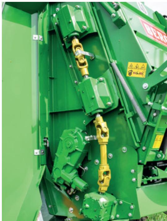
**Sistemul de acționare al mecanismului de împrăștiere** standard cu doi, optional trei cilindri – per transmisie. Întinzătoarea de lanț cu închidere prin resort asigură o transmisie optimă și un grad redus de uzură.
