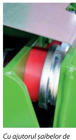
Cu ajutorul șaibelor de distanțare, înălțimea oîștii este reglată în mod ideal pentru fiecare tractor. Elementele de suspensie asigură un grad ridicat de confort în timpul condusului.
