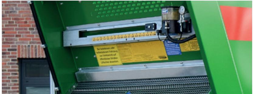
Standard, cu **indicator de înălțime blocator culisant**. **Sistemul central de lubrifiere** optional oferă un flux continuu de lubrifiant, adaptat pentru fiecare lagăr individual. Astfel, eforturile de întreținere sunt reduse în mod considerabil. **Grilajul de protecție** asigură o vedere optimă asupra lanțurilor platformei de transport. Spațiul de încărcare și platforma de transport sunt ușor vizibile prin intermediul ferestrei de inspectare.
