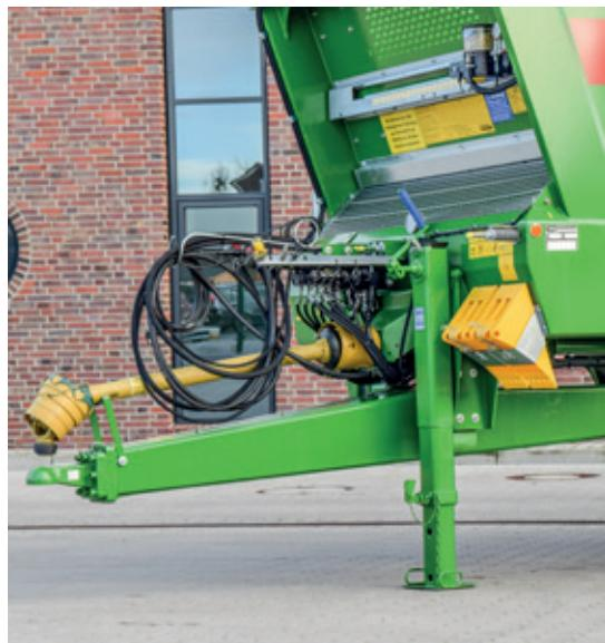
**Oiștea pentru bară de tracțiune inferioară** reglabilă pe înălțime, bazată pe arc și **trolul de susținere „Jost”** pentru o cuplare confortabilă.
