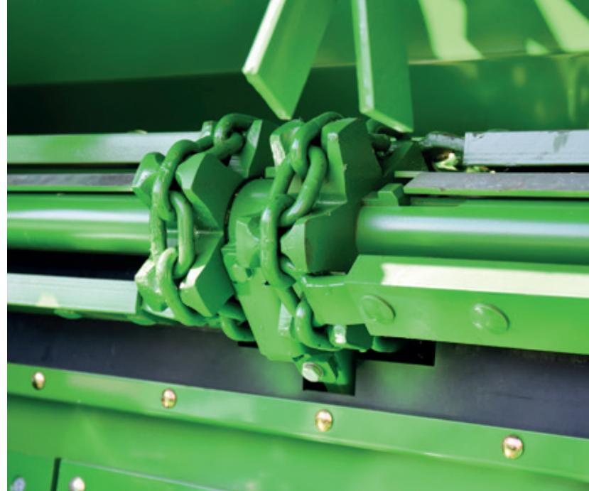
**Mecanismul de împrăștiere** cu blocator culisant hidraulic (Fig. mecanism de împrăștiere optional cu 3 discuri, cu dimensiune 1.800 mm) poate fi utilizat pentru toate tipurile de materiale de dispersie. Sfredelele cu dinți dubli din material foarte rezistent, slab coroziv asigură o capacitate ridicată de perforare.
