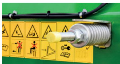
Prin intermediul sistemului automat de tensionare, vizibil din tractor, cele patru lanțuri ultrastabile ale platformei de transport se pot regla foarte ușor din față. Astfel, se obține un grad înalt de siguranță și o funcționare fără probleme.
