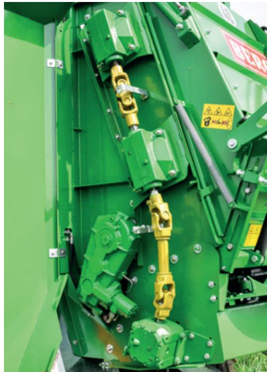
**Sistemul de acționare al mecanismului de împrăștiere** standard cu doi, optional trei cilindri – per transmisie. Întinzătoarele de lanț cu închidere prin resort asigură o transmisie optimă și un grad redus de uzură.
