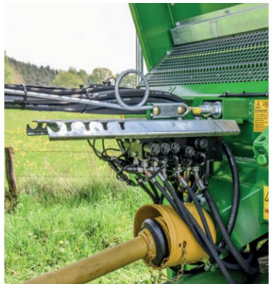
Pentru a facilita utilizarea, **TSW 6240 S** poate fi echipat optional cu un **bloc de comandă hidraulic** și diverse **variante de comenzi**.
