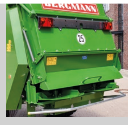
Pokrywa adaptera rozrzucającego Wysokość prześwitu i kąt nachylenia dolnej części kłapy tylnej można ustawiać manualnie zależnie od rozrzucaемого materiału i warunków. W ten sposób można optymalnie ustawić punkt podania materiału na talerze rozrzucające i tym samym uzyskać precyzyjny rozrzut. Zabezpieczenie sprężynowe służy do ochrony przed zanieczyszczeniami.
