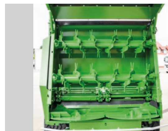
TSW 2120 E / T Adapter rozrzucający SM z prześwitem 1.350 mm. Dwa poziome (opcjonalnie wzmocnione) walce z dokręcanymi stalowymi płaskimi zębami i talerzowym adapterem rozrzucającym z dwoma talerzami, każdy 900 mm Ø i z czterema regulowanymi łapami.
