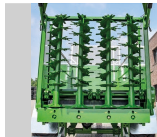
M 2120 SW E / T Adapter rozrzucający SW z prześwitem 1.300 mm. Cztery pionowe walce z dokręcanymi stalowymi płaskimi zębami.
