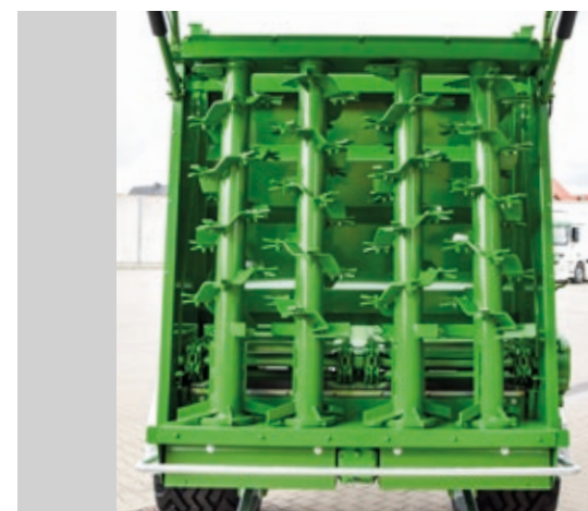
M 2120 SX E / T Adapter rozrzucający SX z prześwitem 1.400 mm. Cztery pionowe, wzmocnione walce z dokręcanymi stalowymi płaskimi zębami.
