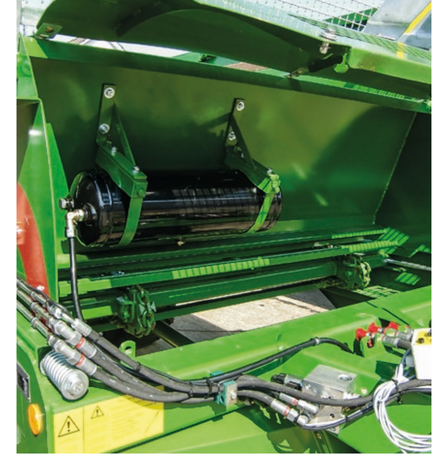
Iso huoltoluukku etuseinässä mahdollistaa pohjakuljettimen helpon puhdistuksen ja huollon. Pohjakuljetin on hyvin nähtävillä etuseinän ikkunan kautta.
