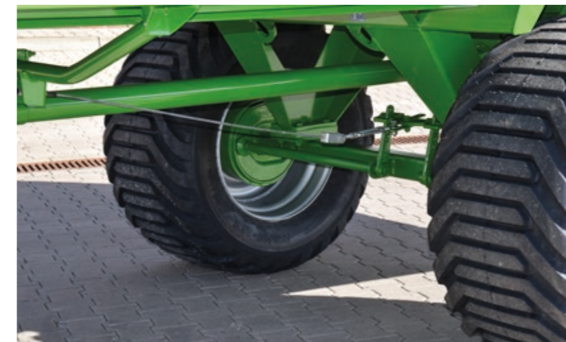
Leveät renkaat ja matala ilmanpaine estävät maan tiivistymisen.
