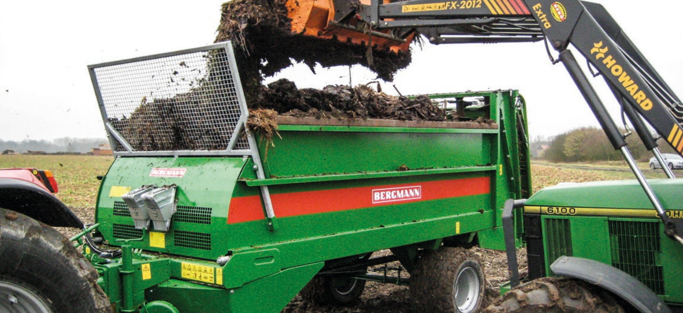
Iso huoltoluukku etuseinässä mahdollistaa pohjakuljettimen helpon puhdistuksen ja huollon. Pohjakuljetin on hyvin nähtävillä etuseinän ikkunan kautta.
