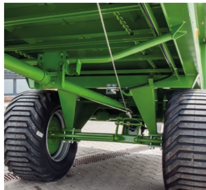
Itsekantavassa kuormatilassa ei tarvita erillistä tukirunkoa ja materiaalin kasautuminen on lähestä mahdotonta. Näiden ominaisuuksien ansiosta huolto- ja puhdisajat on saatu minimiin.
