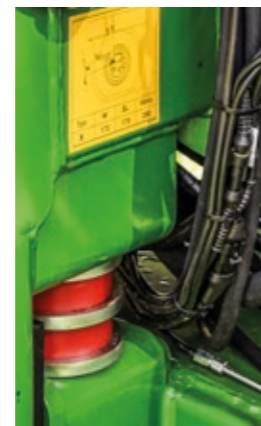
Välilevyjä käyttämällä on mahdollista säätää vetopuomin korkeus eri traktoreita varten. Jousielementit antavat hyvän ajomukavuuden. Hydraulinen vetopuomin jousitus on lisävaruste.
