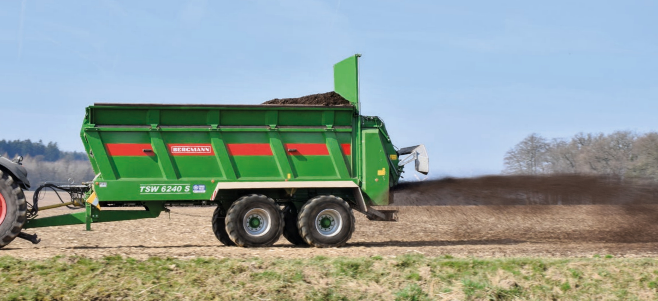
Tarkka annosteluportin korkeuden näyttö on vakiovaruste. Lisävarusteena on keskusvoitelujärjestelmä , joka voitelee keskeytyksettä jokaisen yksittäisen laakerin. Tämä pienentää merkittävästi huoltotarvetta. Suojasäleikkö antaa hyvän näkymän pohjakuljettimen ketjuille. Kuormatila ja pohjakuljetin ovat selvästi näkyvillä ikkunasta.
