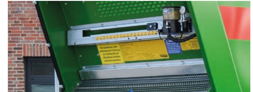
Tarkka annosteluportin korkeuden näyttö on vakiovaruste. Lisävarusteena on keskusvoitelujärjestelmä , joka voitelee keskeytyksettä jokaisen yksittäisen laakerin. Tämä pienentää merkittävästi huoltotarvetta. Suojasäleikkö antaa hyvän näkymän pohjakuljettimen ketjuille. Kuormatila ja pohjakuljetin ovat selvästi näkyvillä ikkunasta.
