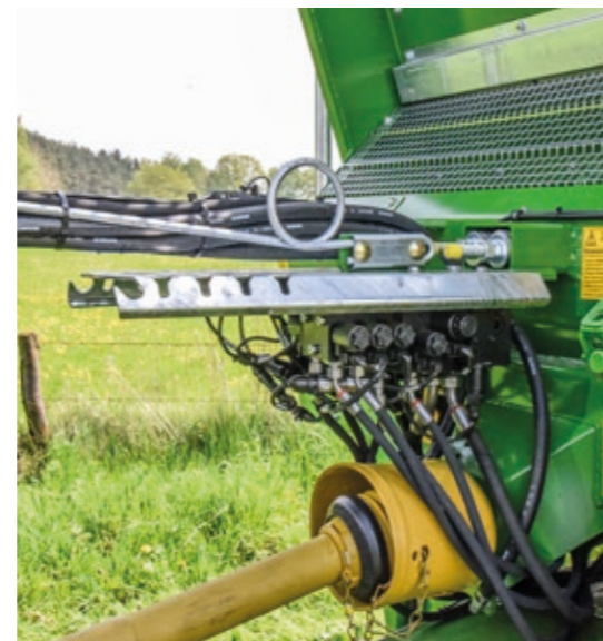
TSW 6240 S voidaan lisävarusteena varustaa hydrauliikkalohkolla ja erilaisilla hallintalaitteilla käyttömukavuuden lisäämiseksi.
