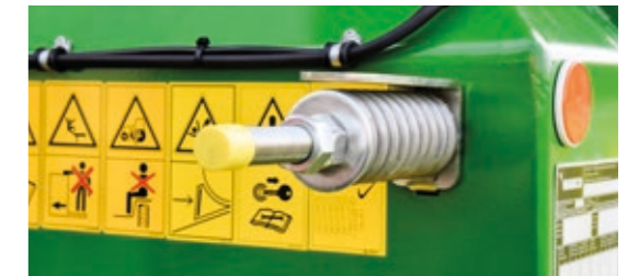
Automaattista kiristysjärjestelmää voidaan tarkkailla ohjaamosta ja neljää suuren lujuuden omaavaa pohjakuljettimen ketjua voidaan helposti säätää edestä. Näin voidaan varmistaa turvallinen ja joustava käyttö.
