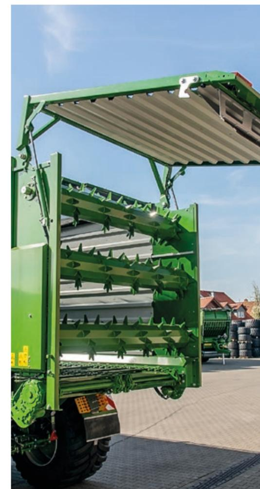
Weit öffnende, stabile **Heckklappe** mit mechanischer Verriegelung - für ein schnelles Entladen.
