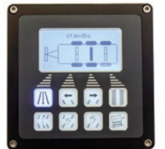
Schaltpult elektrohydraulische Zwangslenkung
