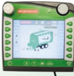
Optionale **ISOBUS-Bedienterminals CC 150 / CCI 200** – einfache Bedienung und Einstellung aller Funktionen, Lade- und Entladeautomatik, programmierbare Steuerfolge, farbiges Touchscreen-Display, vielfache Schnittstellenmöglichkeiten, Möglichkeit der Kamerabild-Darstellung.
