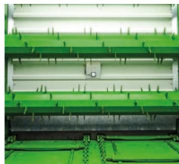
**Füllstandserfassung** – optional – über Ultraschallsensor in der Heckklappe. Der Füllstand des Laderaums wird als Prozentwert im Terminal angezeigt.
