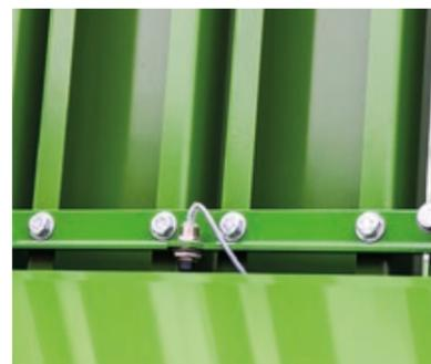
**Befüllautomatik** – optional – über Sensor im Befüllkanal und in der Befüllhaube.
