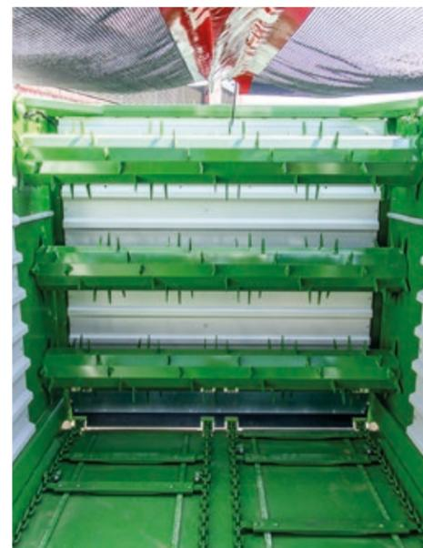
Dosieraggregat der **S-Modelle** mit serienmäßig drei Dosierwalzen (**SHUTTLE 450 S** / **SHUTTLE 490 S**).
