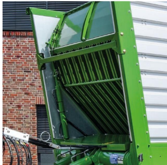
Der Laderaum wird durch den breiten **Förderkanal** optimal befüllt. Der nach vorne um 275 mm **abgesenkte Stahl-Transportboden** reduziert die Förderkanalhöhe und bedingt einen deutlich geringeren Kraftaufwand für den Rotorantrieb, schont das Futter und erhöht die Ladeleistung. Die im vorderen Bereich glatten Innenseiten und Seitenwände reduzieren Reibungskräfte beim Befüllvorgang.
