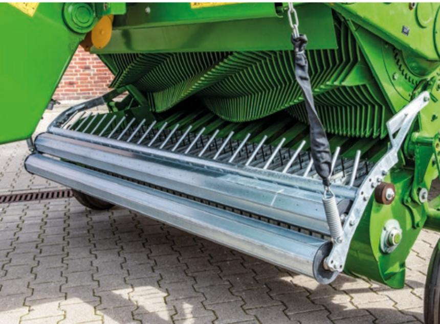
Für eine optimale Boden Anpassung ist die **Tastwalze** für die Pick-up optional erhältlich. Die – ebenfalls optional erhältliche – **Pick-up-Entlastung** sorgt dafür, dass die Pick-up stets mit konstantem Auflagedruck sanft über den Boden rollt und das Futter sauber aufnimmt.
