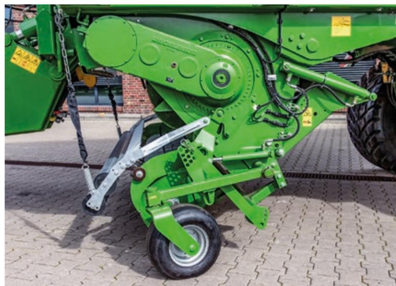
Der **Rotorantrieb** erfolgt über ein leistungsstarkes Planetengetriebe. Dies verfügt in seiner kompakten Bauweise über erhebliche Leistungsreserven und ist somit für größte Schlepper ausgelegt.
