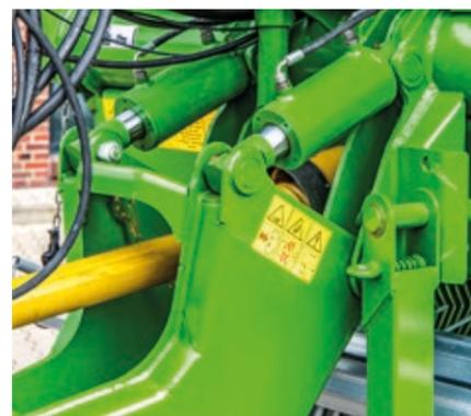
Die **Anhängehöhe** lässt sich, in Verbindung mit dem **Wegmesssystem** am Knickdeichselzylinder, einfach über das ISOBUS-Terminal verstellen und programmieren. Dabei können verschiedene Höhen für den Lade-, Entlade- und Straßenmodus gespeichert werden.
