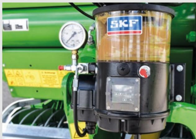
Die optionale **Zentralschmierung** ermöglicht kontinuierlich die auf jede Lagerstelle individuell angepasste Fettzufuhr. So wird der Wartungsaufwand erheblich reduziert.
