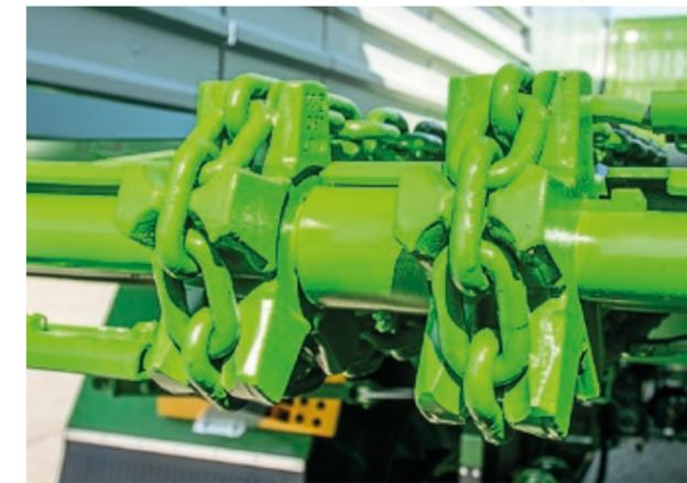
Die vier **Rundstahlketten** (je 14 x 50 mm, 25 t/Kette) sind tief in große Kettennüsse eingebettet (wenig Verschleiß), die Ketten paarweise gestreckt. Umlenkrollen, vorne und hinten mit Räumern, sorgen für eine sichere Führung der Transportbodenketten. Die Vorschubleisten laufen auf separaten Verschleißschielen.
