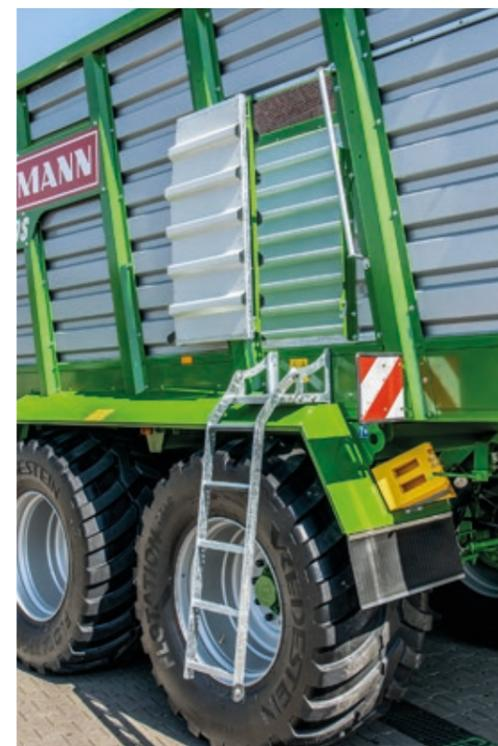
Der **Aufbau** mit soliden Rahmenprofilen (350 mm Höhe) und robusten, breiten Seitenwandungen sorgt für eine hohe Stabilität. Der große, arretierbare **Laderaumeinstieg** ist seitlich angebracht und ermöglicht einen bequemen Einstieg über die ausklappbare, tief reichende Leiter.
