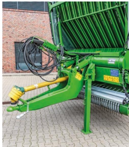
Die **SHUTTLE**-Modelle sind serienmäßig mit Untenanhängung und Kugelkopfkupplung K 80 ausgestattet. Nachlaufkackse, hydraulisch sperrbar, ist Serie.
