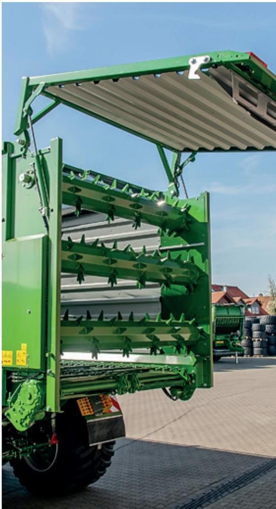
*La porte, dotée d'un verrouillage mécanique, offre un grand dégagement pour une vidange rapide.*
