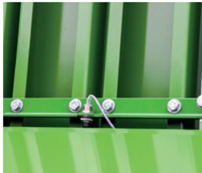
Le système de **chargement automatique** – proposé en option – utilise un capteur contrôlant la pression appliquée sur la paroi frontale.
