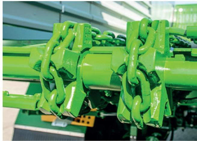
Les quatre chaînes en acier (chacune de 14 x 50 mm, 25 t de traction par chaîne) sont profondément engrainées dans de grandes noix d'entraînement (usure limitée). Des grattoirs limitent l'encrassement des noix avant et arrière afin d'assurer un guidage fiable des chaînes.
