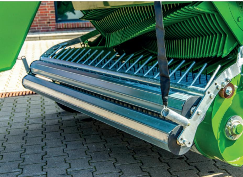
Pour un suivi optimal des sols accidentés, le **rouleau d'appui central** préservera la propreté du fourrage. Le système de **soulagement à boule d'azote du Pick-up** limite la pression d'appui sur les roues de jauge tout en garantissant un ramassage optimal du produit.
