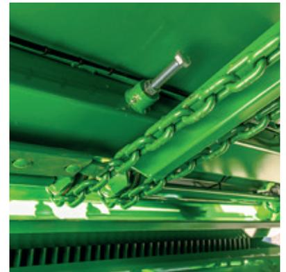
Les tendeurs des chaînes sont lubrifiés et facilement accessibles depuis le dessous de la machine.
