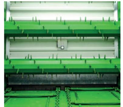
L'indicateur du **niveau de remplissage** utilise un capteur à ultrasons, placé sur la porte arrière, indiquant en temps réel le volume de la remorque occupé par le fourrage.
