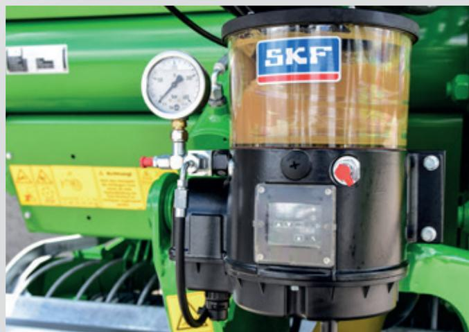
Le système de **graissage centralisé** lubrifie en continu tous les axes et paliers de la machine. L'usure et les opérations de maintenance s'avèrent ainsi particulièrement limitées.
