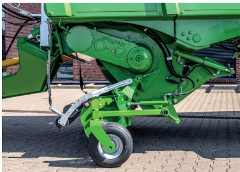
Le rotor de coupe est entraîné via un boîtier à cascade de pignons suivi d'un réducteur à planétaires. Ce montage très compact et robuste admet la puissance et le couple des plus gros tracteurs.
