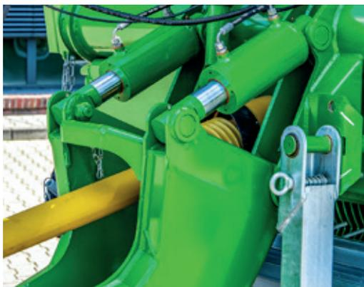
*La hauteur du timon d'attelage peut être facilement réglée via le terminal ISOBUS grâce aux capteurs intégrés dans les vérins d'articulation du timon. Différentes hauteurs peuvent être stockées pour le chargement, le déchargement et le mode routier.*
