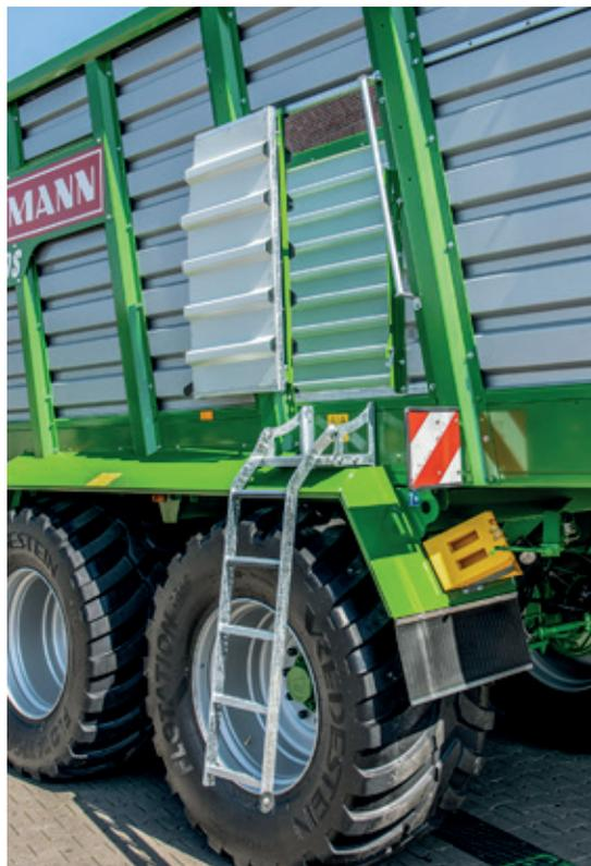
Le **châssis** se compose de poutres de 350 mm de haut, particulièrement robustes, et de parois latérales larges offrant une grande stabilité. La grande porte d'accès à la caisse et l'échelle escamotable facilitent l'accès à bord.
