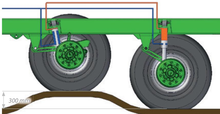
**Châssis à suspensions hydrauliques**
