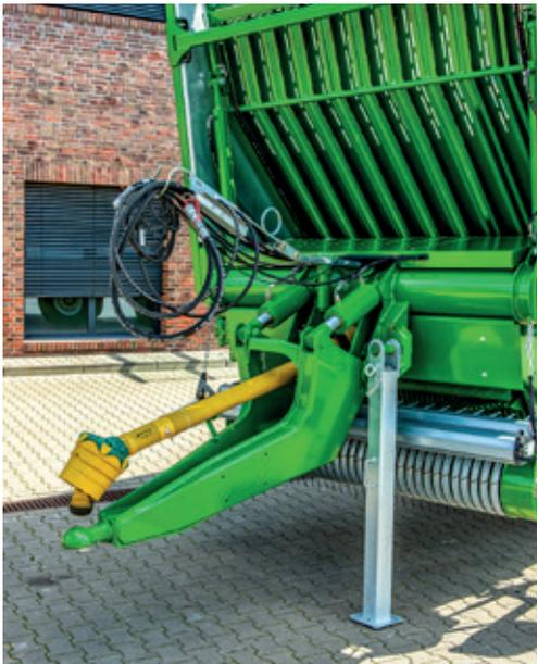
La gamme d'autochargeuses **CAREX** bénéficie de série d'un timon bas intégrant un crochet à rotule K80. L'essieu suiveur à verrouillage hydraulique est également monté de série.
