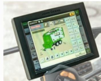
Alle **ROYAL**-Modelle sind serienmäßig ISOBUS-fähig. Die Auswahl der verschiedenen Bedienvarianten ermöglicht eine angepasste und bequeme Bedienung.
