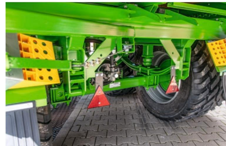
Alle **ROYAL**-Modelle sind mit einem hochwertigen **4-Feder-Aggregat** ausgestattet. Dieses bietet hohe Standfestigkeit, Fahrkomfort und Leichtzügigkeit.
