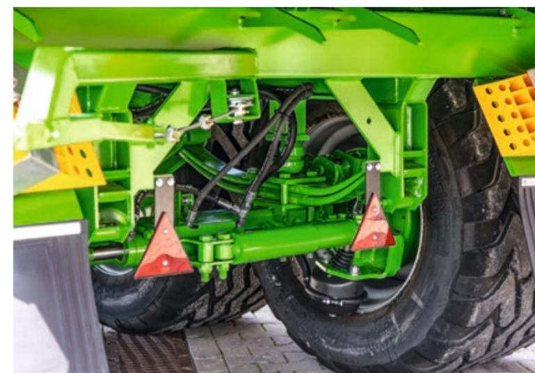
Für noch höheren Fahrkomfort, deutlich geringeren Reifenschleiß und mehr Bodenschonung ist eine **Nachlauf-Lenkung** optional erhältlich.
