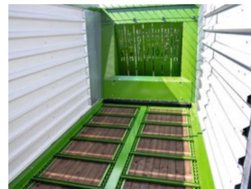
Der **Laderaum mit Holzboden** wird durch den Förderkanal optimal befüllt. Die im vorderen Bereich glatten Innenseiten und Seitenwände reduzieren Reibungskräfte beim Befüllvorgang.
