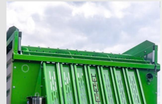
Eine **Befüllhaube** mit **Befüllautomatik** mit einstellbarer Zeitverzögerung ist optional erhältlich. Je nach Einstellung kann das Ladegut mehr oder weniger verdichtet werden.
