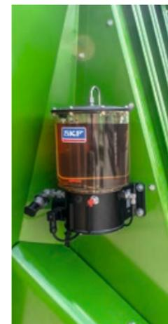
Das 2-Rotor-Aggregat wird mit einer starken **Spezial-HD-Rollenkette** angetrieben. Die serienmäßig eingebaute automatische **Schmierung** für Rotor- und Pick-up-Antriebskette sorgt für Langlebigkeit und Zuverlässigkeit des Antriebssystems.
