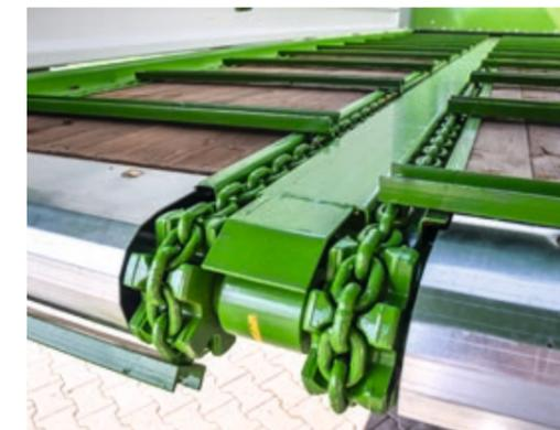
Die vier **Rundstahlketten** (je 11 x 31 mm, 15 t/Kette) sind tief in große Kettennüsse eingebettet (wenig Verschleiß), die Ketten paarweise gestreckt. Umlenkrollen, vorne und hinten mit Räumern, sorgen für eine sichere Führung der Transportbodenketten.
