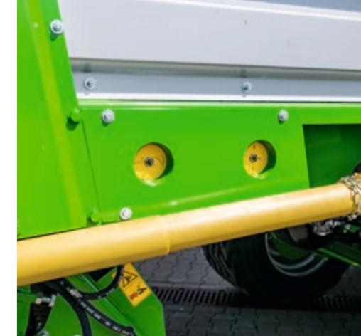
Die Einstellung der **Deichsel** und des **Messerbalkens** erfolgt bequem an der linken Fahrzeugseite.
