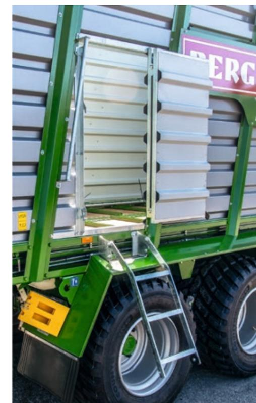
Der große, arretierbare **Laderaumeinstieg** ist bei den S-Modellen serienmäßig, bei den K-Modellen optional erhältlich. Er ist seitlich in Fahrtrichtung rechts angebracht und ermöglicht einen bequemen Einstieg über die ausklappbare, tief reichende Leiter.
