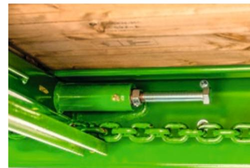
Die abschmierbaren Führungen der **Kettenspanner** sind gut zugänglich und erlauben so ein einfaches Nachspannen der Ketten.
