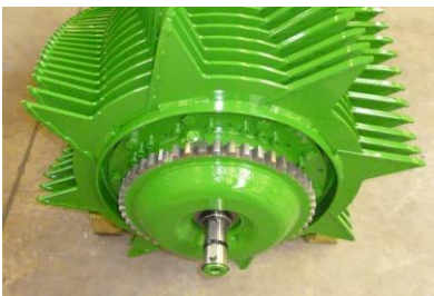
B02-1213 Füllmenge 3,2 Liter Getriebeöl: ISO VG 460 Synthetiköl
