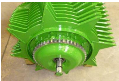
B02-1213 Vulhoeveelheid 3,2 liter Drijfwerkolie: • ISO VG 460 synthetische olie
