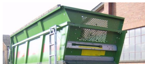
Bild: Påbyggnadsvägg 450 mm (utåtlutande)
