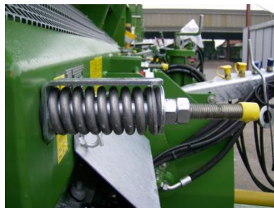
Bild: Inställning av transportbottenkedja (ytterst)
