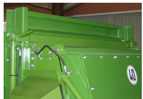
Bild: Påbyggnad för doseringsplatta
