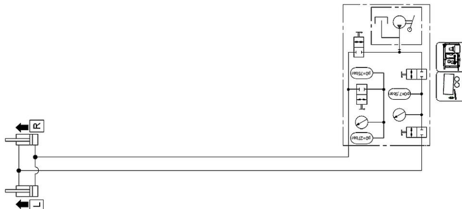
Bild 102: Hydraulikschema manuell styrning (2)
