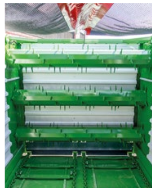
Doseeraggregaat van het S-model met standaard drie doseerwalsen ( CAREX 370 S / CAREX 410 S ).
