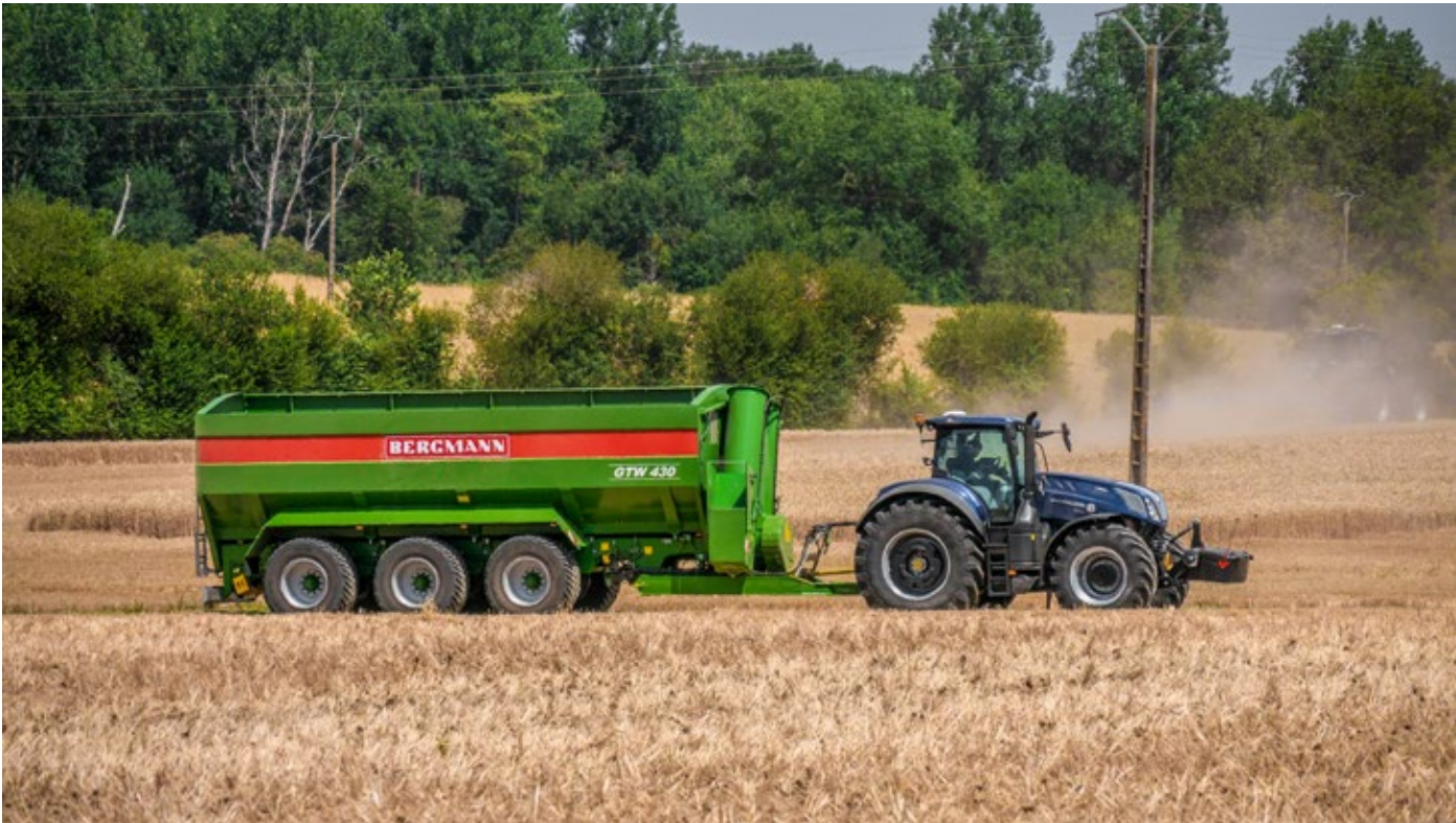
GTW 430 Der GTW 430 ist mit 43 m³ Ladevolumen das Flaggschiff der BERGMANN Überladewagen. Die Überladeleistung liegt bei ca. 1.100 t/h.
