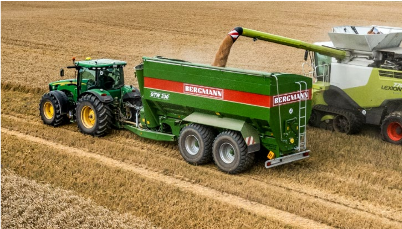
GTW 330 Mit 33 m³ Ladevolumen macht der GTW 330 den Einstieg in die Oberklasse der BERGMANN Überladewagen. Die Überladeleistung liegt bei ca. 1.100 t/h.
