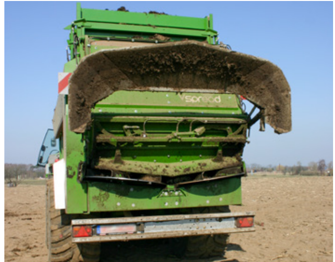
Het V-Spread strooiwerk met 1.100 mm diameter van de strooischijven en zes strooivleugels.
