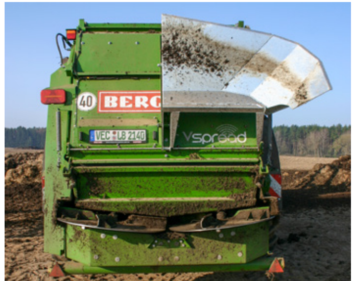
Het V-Spread strooiwerk met 1.000 mm diameter van de strooischijven en vier strooivleugels.
