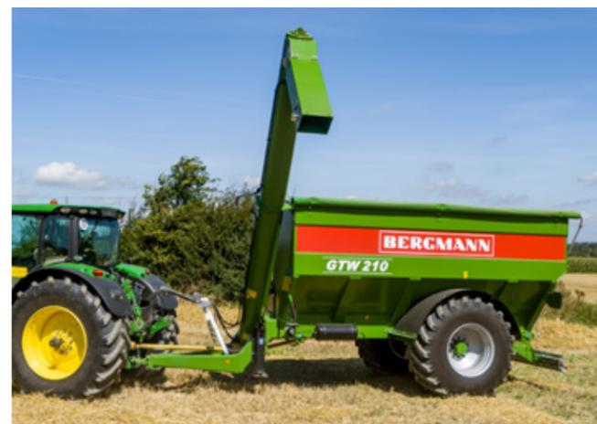
Pour l'attelage, il est possible de choisir entre différents anneaux d'attelage. L'attelage à boule disponible en option offre un confort de conduite maximal avec une usure minimale. Les flexibles hydrauliques sont bien fixés dans le support prévu à cet effet et donc bien protégés de la saleté.
