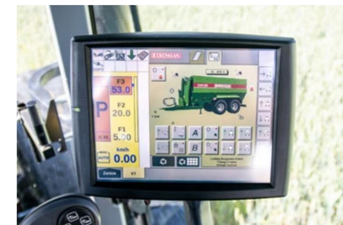
тракторе никакого другого терминала в его кабине Вам не потребуется. Благодаря чему механизатору не будет переключаться обзор, что, безусловно, повысит безопасность движения на дороге, и облегчит работу в поле. Со стороны трактора требуется всего лишь один гидрораспределитель одностороннего действия и обратный слив. В качестве опции может предлагаться система Load-Sensing
