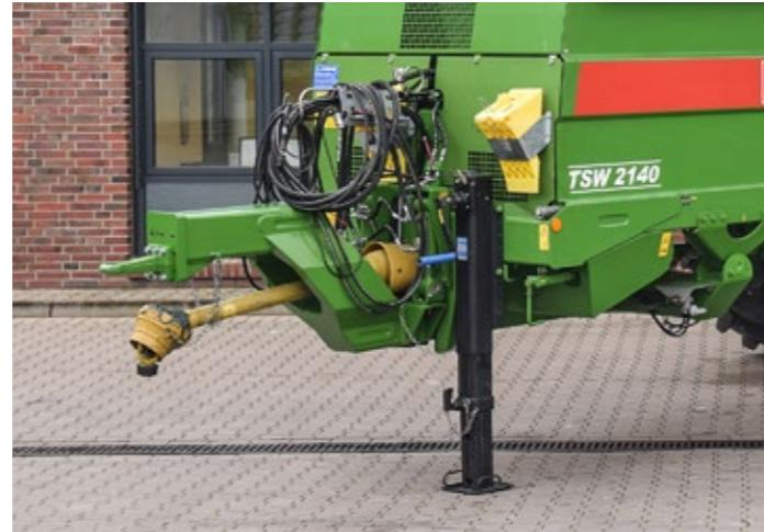
Sériové připojení pomocí tažné koule nabízí maximální jízdní komfort při nejnižším opotřebení. Hydraulické hadice jsou úhledně zavěšené v hadicové skříně a jsou tak chráněny před znečištěním.
