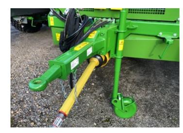
Le M 1080 SW est proposé avec un anneau d'attelage d'un diamètre de 40 mm. Les flexibles hydrauliques sont fixés dans un support prévu à cet effet afin de les protéger efficacement de la saleté.
