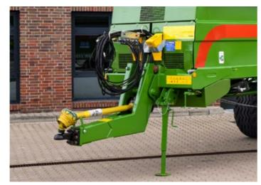
Pour l'attelage, il est possible de choisir entre différents types d'anneaux. Disponible en option, l'attelage à boule offre un confort de conduite maximal avec une usure minimale. Les flexibles hydrauliques sont bien fixés dans le support prévu à cet effet et donc bien protégés de la saleté.
