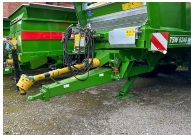
Pour l'attelage, il est possible de choisir entre différents anneaux d'attelage. L'attelage à boule disponible de série offre un confort de conduite maximal avec une usure minimale. Les flexibles hydrauliques sont bien fixés dans le support prévu à cet effet et donc bien protégés de la saleté.
