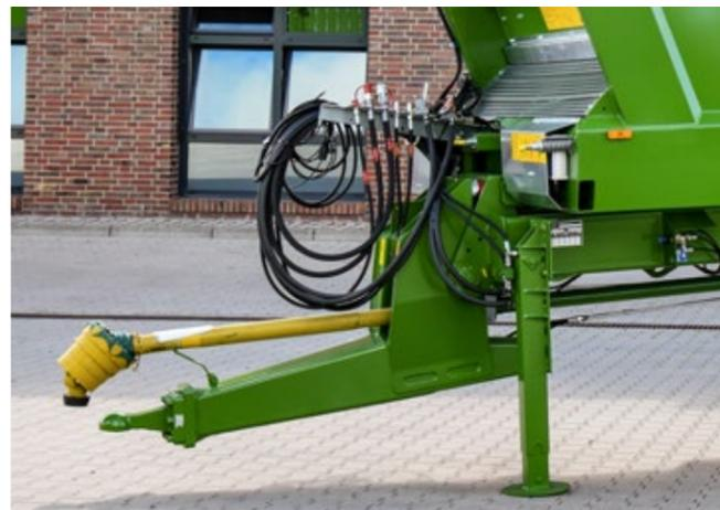
Pour l'attelage, il est possible de choisir entre différents anneaux d'attelage. Disponible en option, l'attelage à boule offre un confort de conduite maximal avec une usure minimale. Les flexibles hydrauliques sont bien fixés dans le support prévu à cet effet et donc bien protégés de la saleté.
