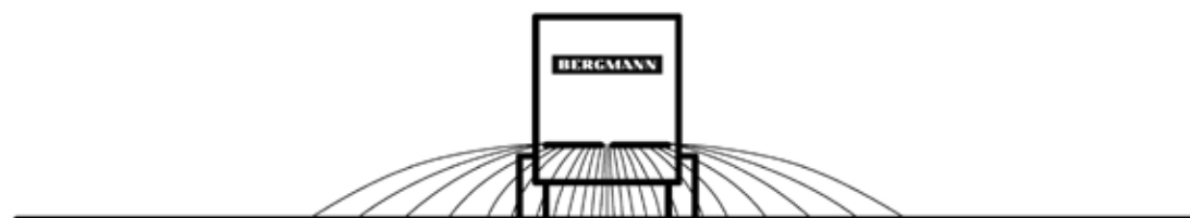
Wynik rozrzucania ze standardowym adapterem rozrzucającym
